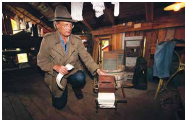
Olle Magnusson visar en fasoneringsmaskin, en liten varm-mangel för att få fason på stärkkragarna. Den värmdes med gas.
